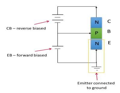
COMMON EMITTER AMPLIFIER CIRCUIT
