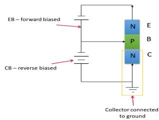
COMMON COLLECTOR AMPLIFIER CIRCUIT
