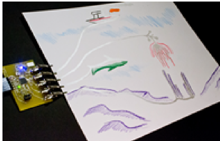
Litar elektronik di atas kertas dengan menggunakan dakwat pengalir (sumber: Jacoby and Buechley, 2013)
